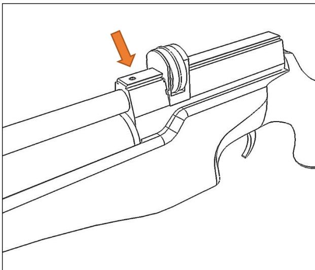
Si fuera necesario retirar el cañón para realizar una limpieza del mismo, o para reemplazar una junta, solamente se tiene que retirar el tornillo situado en la parte superior de la unión con el cuerpo de la carabina. Con el tornillo quitado ya podemos extraer el cañón tirando del mismo hacia afuera.
